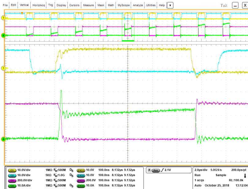
图 8-6. SiC MOSFET 开关波形
