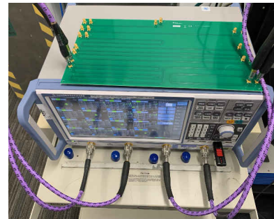
图 1-3. 具有 SMA 连接器的 FR4 电路板
