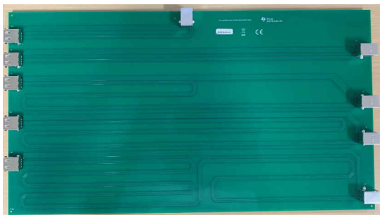
图 1-2. 具有 USB 2.0 插座的 FR4 电路板
