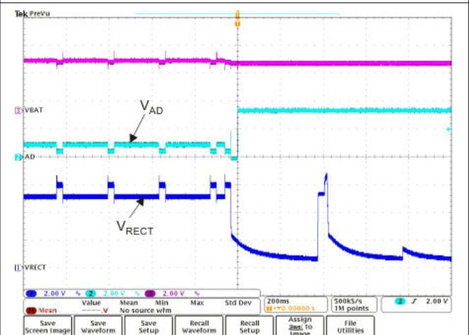
图 7-16. 启用 On-the-Go ( $V_{OTG} = 3.5V$ )<sup>(3)</sup>
