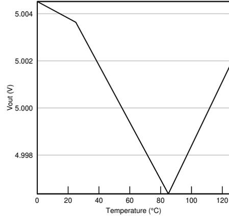
图 7-8.  $V_{OUT}$  与温度间的关系
