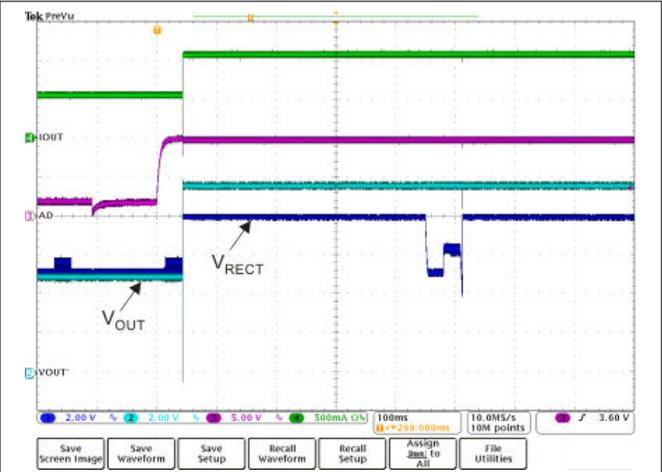
图 7-14. 适配器插入 ( $V_{AD} = 10V$ )
