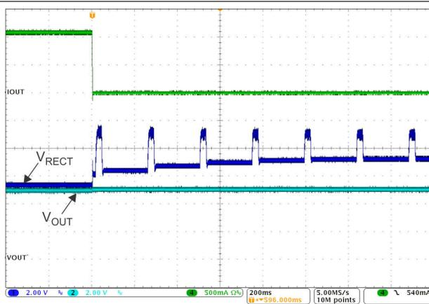
图 7-11. 1A 负载突降完整系统响应
