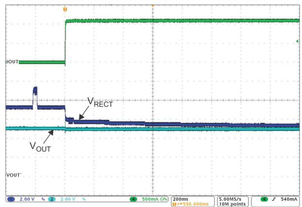
图 7-10. 1A 负载阶跃完整系统响应
