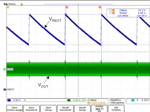
图 7-12. 整流器过压钳位 ( $f_{op} = 110\text{kHz}$ )
