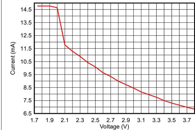
图 7-12. TX 电流与电源电压 (VDDS) 间的关系 ( BLE 1Mbps , 2.44GHz , 0dBm )
