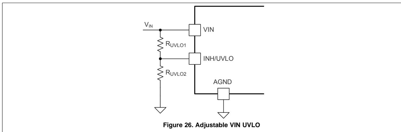
Figure 26. Adjustable VIN UVLO
