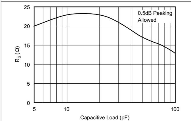
图 5-73.  $R_S$  vs Capacitive Load
