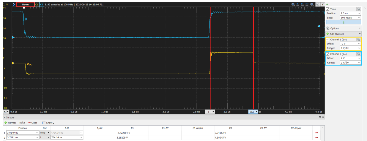
图 9-6. THVD1426 使用 D 输入、显示自动方向控制的波形
