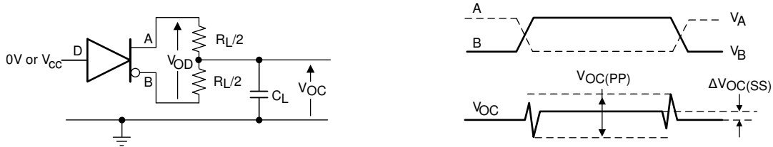
图 7-2. 具有 RS-485 负载的驱动器差分 and 共模输出的测量
