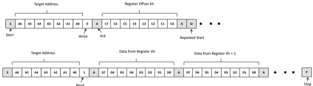
图 7-4. 使用重复启动的 I 2 C 读取
