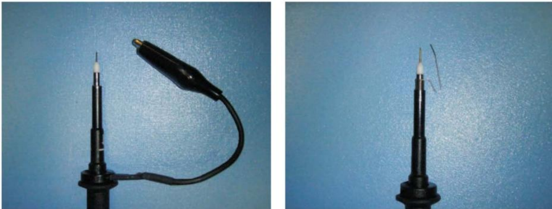
图 7. 示波器探头的比较：3 英寸标准探头（左图）和 短线探头（右图）
