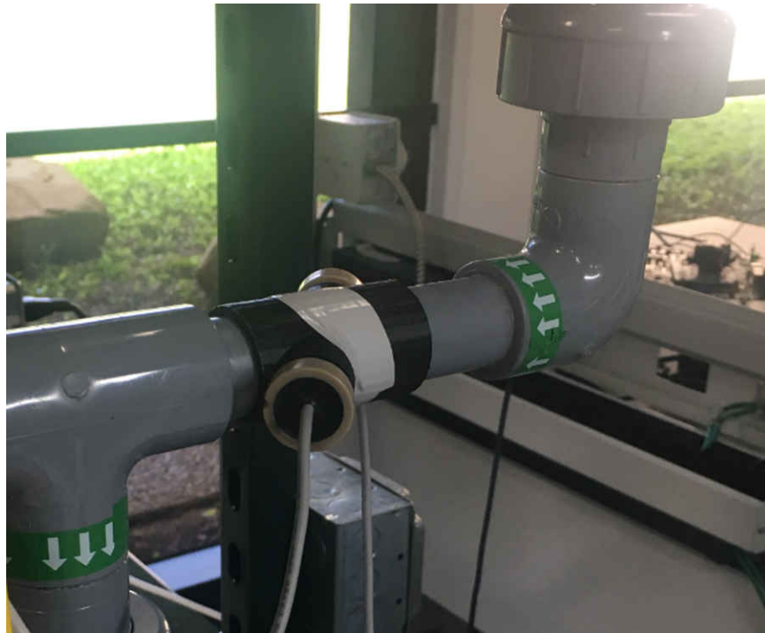
图 2-2. 流量计测试设置
