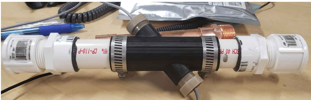
图 1-3. 附加了 PVC 管的 3D 打印装置
