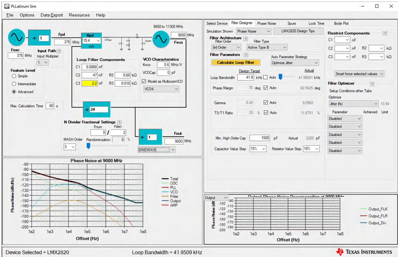
图 4-3. 外部 VCO PLLatinum™ 仿真 GUI 环路滤波器
