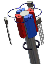
图 6. 使用 TO-92 霍尔传感器的转子位置
