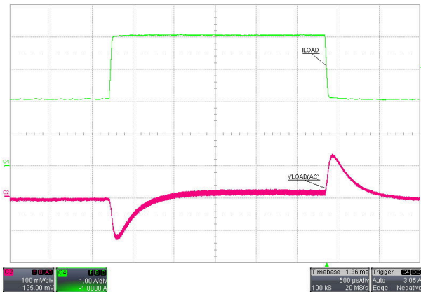
图 4-4. 负载阶跃 : I_{LOAD} 2A 至 4A , V_{SUPPLY} = 18V
