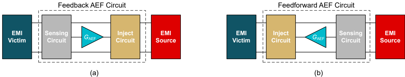
图 4-1. 具有检测、增益和注入级的 AEF 的基本概念。控制结构可以是 FB (a) 或 FF (b)
