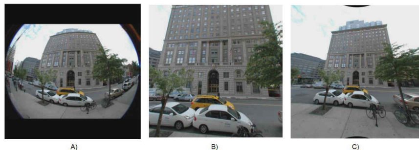
图 5-1. 镜头失真校正：A) 鱼眼镜头拍摄的未加工帧，B) 正面透视输出图像，C) 中间网格图像 - 使用等积鱼眼投影模型扭曲和内插，将图像投影为全分辨率矩形格式
