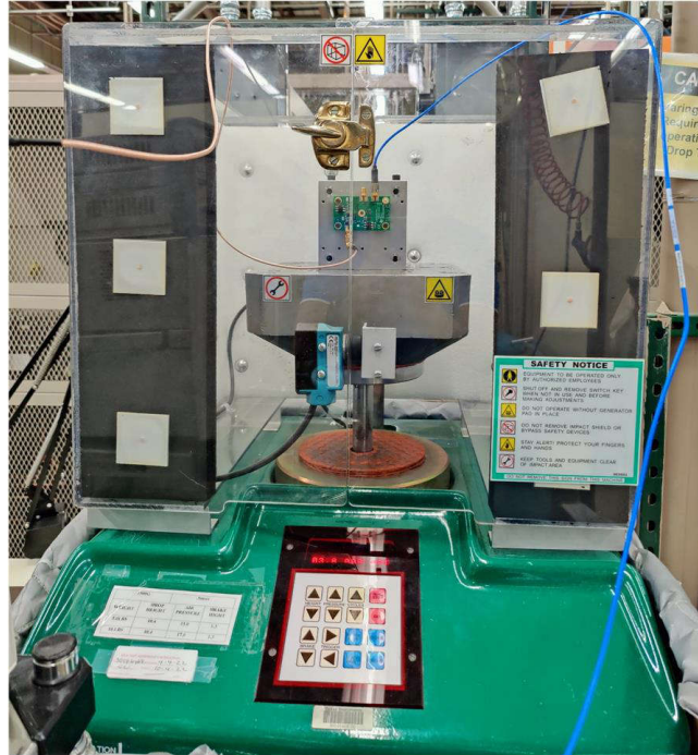
图 3-19. 冲击测试设置
