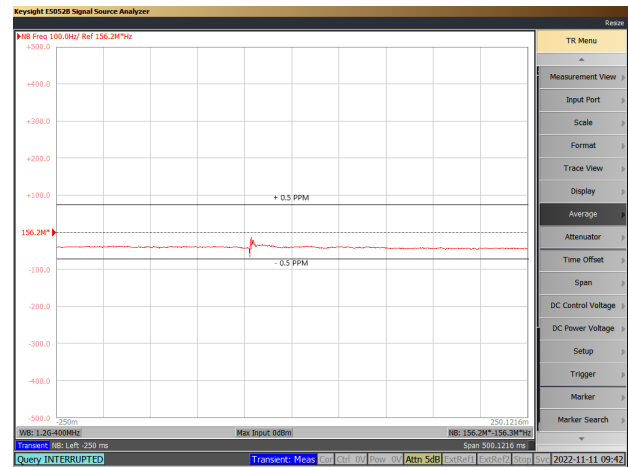
图 3-21. 4 引脚 DLE 在机械冲击测试期间的捕获数据，Z 轴
