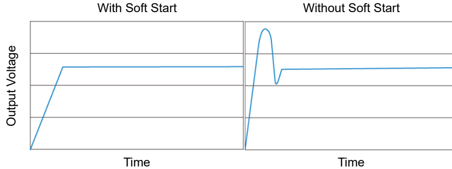
图 1-1. 使用和不使用软启动功能时的输出电压
