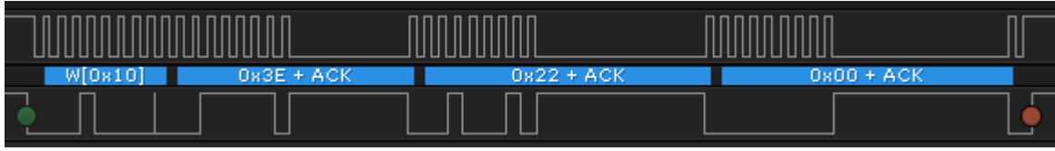
图 2-2. 为 FET_ENABLE 子命令捕捉的 I2C 波形
