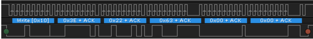
图 4-1. 使用 CRC 为 FET_ENABLE 子命令捕捉的 I2C 波形
