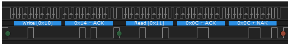
图 1-2. 为读取 Cell 1 电压捕捉的 I2C 波形
