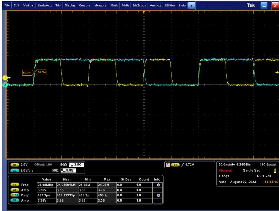
图 2-13. RGMII 对齐模式下的 RX\_CLK 和 RX\_D0 时序 (黄色波形 (通道 1) = RX\_CLK, 蓝色波形 (通道 2) = RX\_D0)
