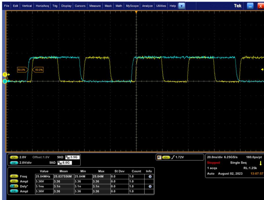
图 2-14. RGMII RX 移位模式下的 RX\_CLK 和 RX\_D0 时序 (黄色波形 (通道 1) = RX\_CLK, 蓝色波形 (通道 2) = RX\_D0)
