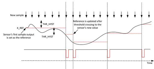
图 4. TMAG3001 通过磁轴测量进行变化时唤醒
