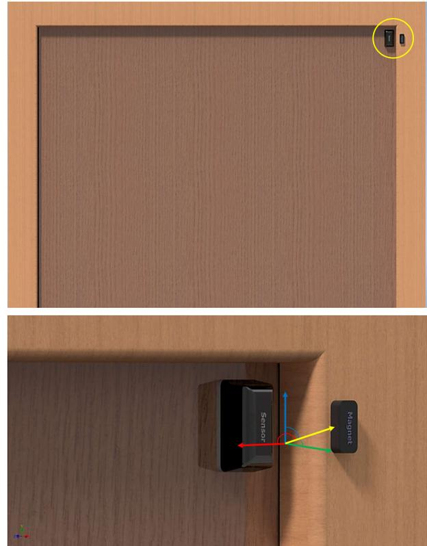
图 1. 典型的带凸出门框的门装式传感器
