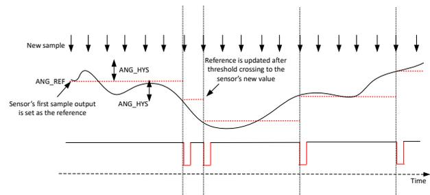
图 5. TMAG3001 通过角度测量进行变化时唤醒
