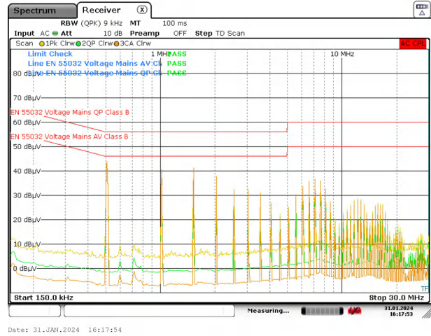
图 5-12. 使用电感器滤波器时的 TPSM843A22 传导 EMI 结果
