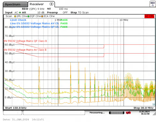
图 5-10. 使用电感器滤波器时的 TPS543A22 传导 EMI 结果
