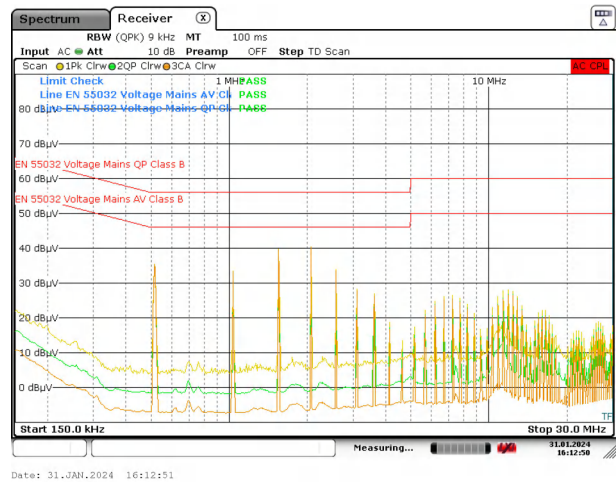
图 5-6. 使用电感器滤波器时的 TPS543820 传导 EMI 结果
