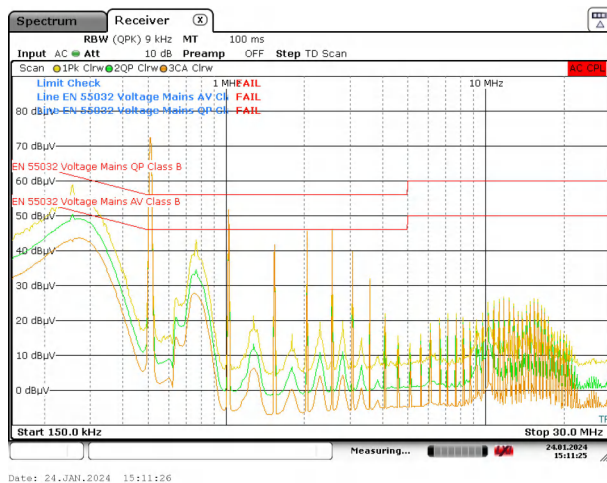
图 5-7. 使用铁氧体磁珠滤波器时的 TPSM843620 传导 EMI 结果
