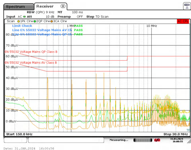
图 5-8. 使用电感器滤波器时的 TPSM843620 传导 EMI 结果
