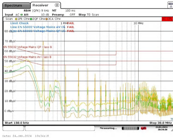
图 5-5. 使用铁氧体磁珠滤波器时的 TPS543820 传导 EMI 结果
