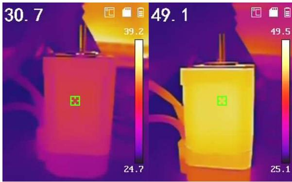
图 3-6. 电机中的温差 - SPS 模式已禁用
