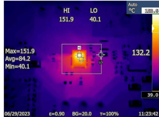
图 3-4. DRV8317 在 50kHz PWM 频率和 2.99A RMS 条件下的热像图
