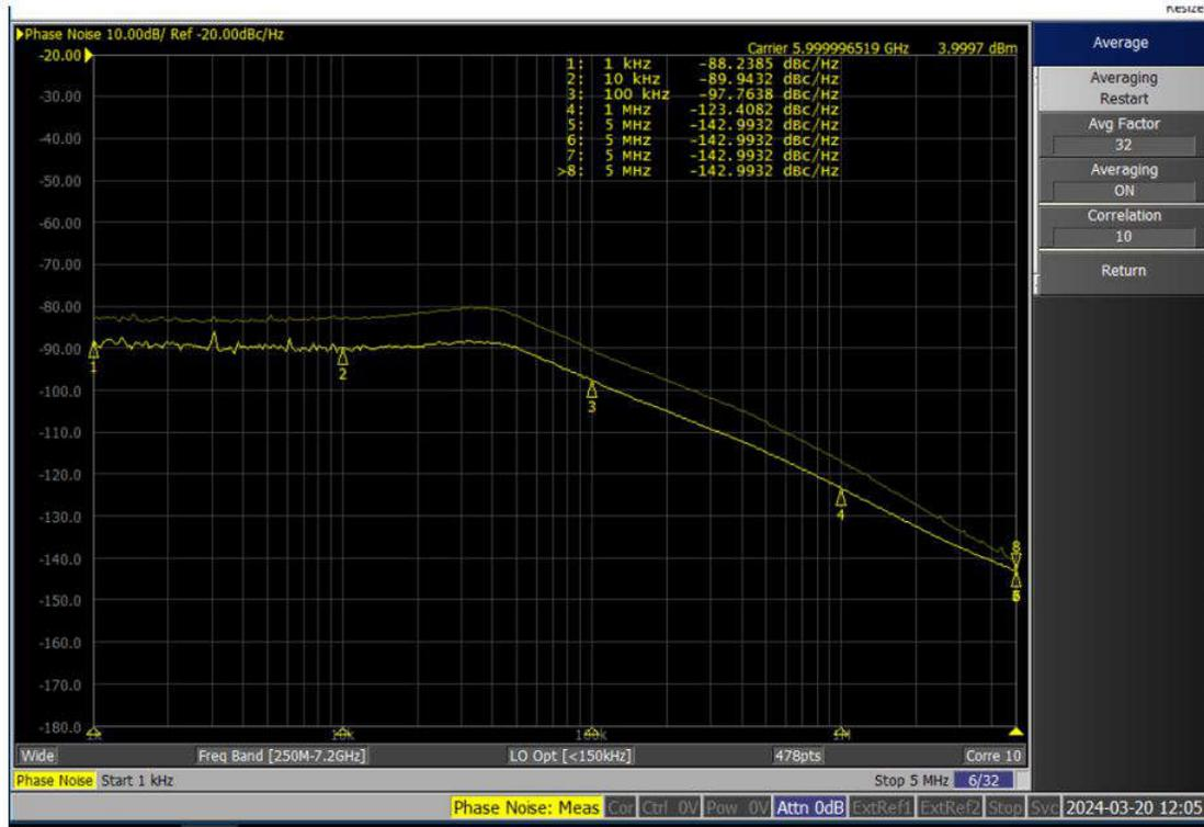
图 8. 具有 -5dBm 和 10dBm 基准 (OSCIN) 电平的 LMX2820 上的 6GHz 输出
