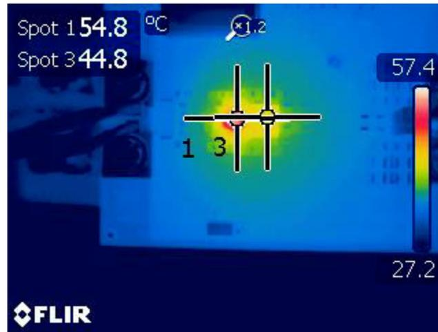
图 3. 单个 TPS6287B25 在室温下以 3.3V  $V_{IN}$  为 0.45V 电压轨提供 20A 直流电流
