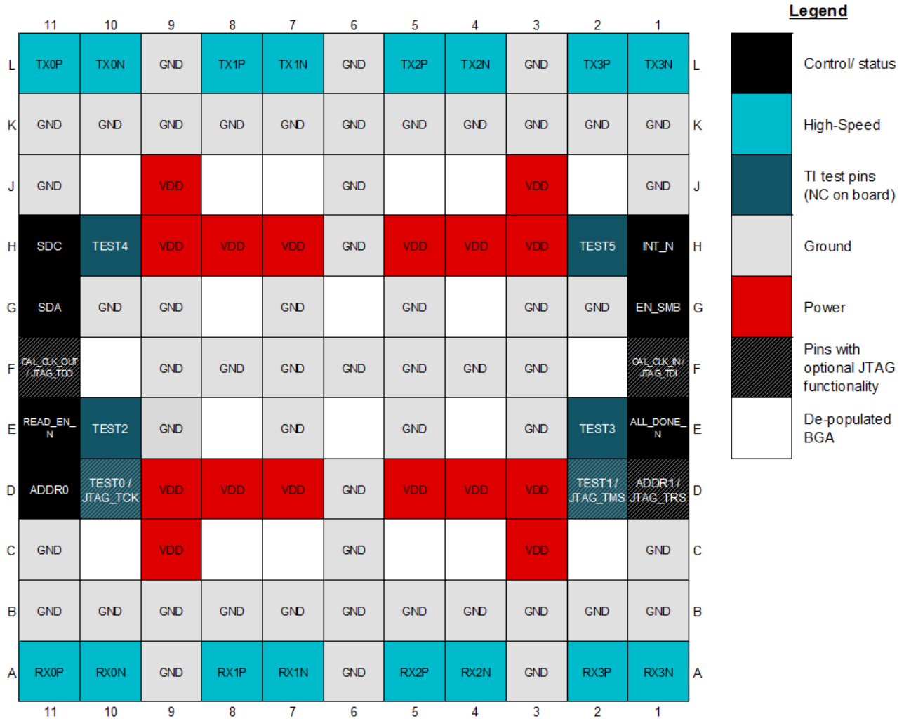
图 2-2. DS250DF410 引脚配置
