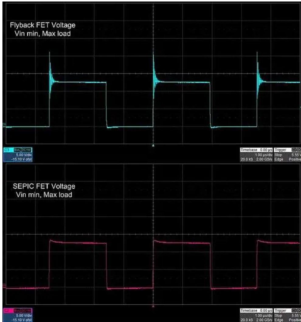
图 2. SEPIC FET 上的电压振铃比反激式低，因此可降低应力并改善输出电压调节性能。
