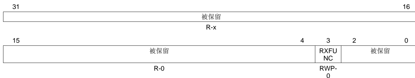
图 28. RX I/O 控制寄存器 (CANRIOC)
