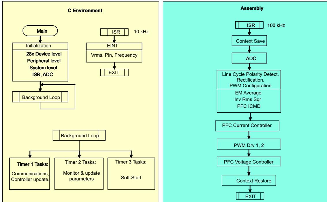
图 4. IL PFC Software Flow Diagram
