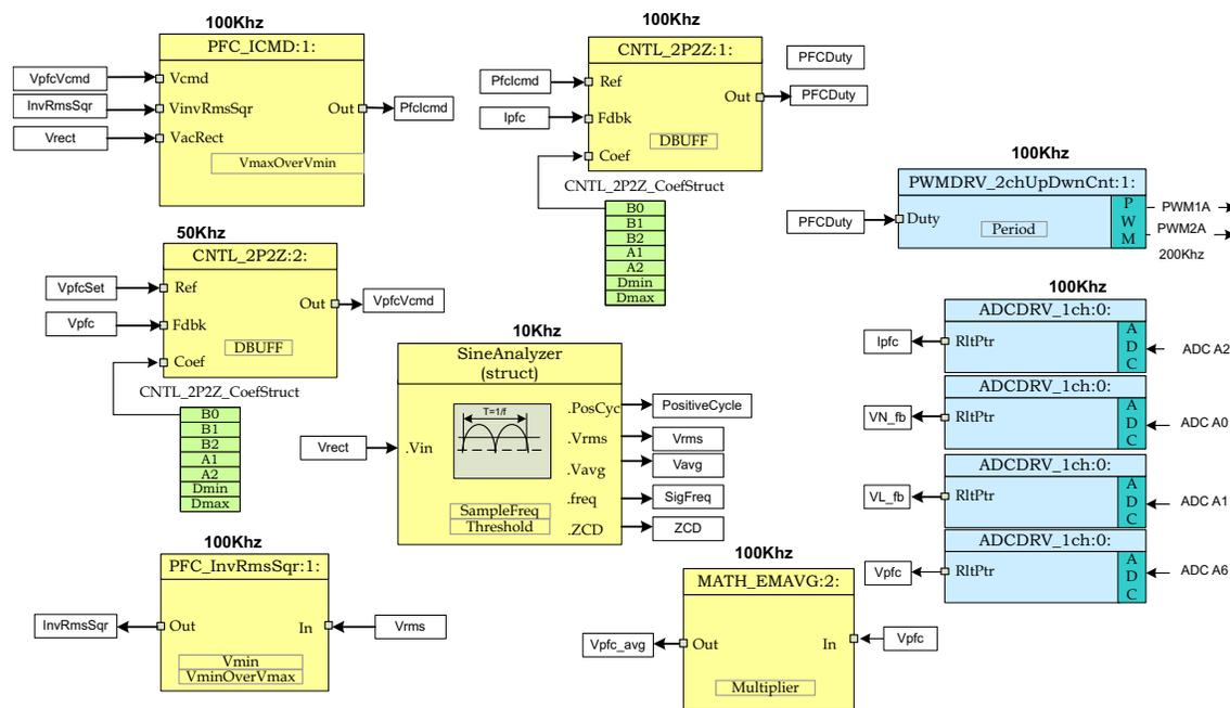
图 5. C2000 ILPFC Software Modules
