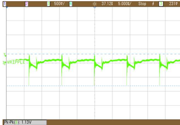
图 19. Boost Converter Output Ripple
