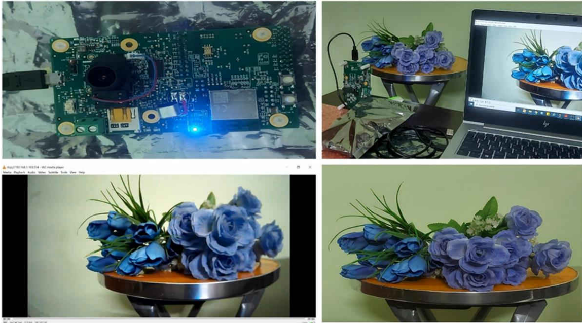
图 3-22. 视频流式传输 - 摄像头模块 (左上)、摄像头视频流式传输对象 (右上)、VLC 上的摄像头视频流式传输 (左下)、对象 (右下)
