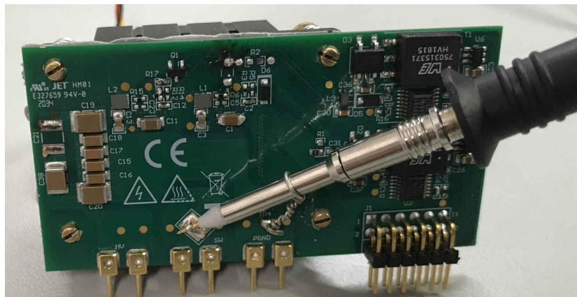
图 7-3. 利用高带宽探头和尾纤接地连接进行开关节点电压测量
