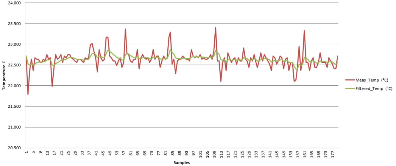
图 3-10. Alpha 值为 0.2 的低通滤波器响应
