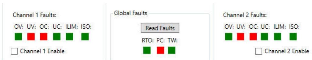
图 7-9. 按下读取故障后的故障状态
