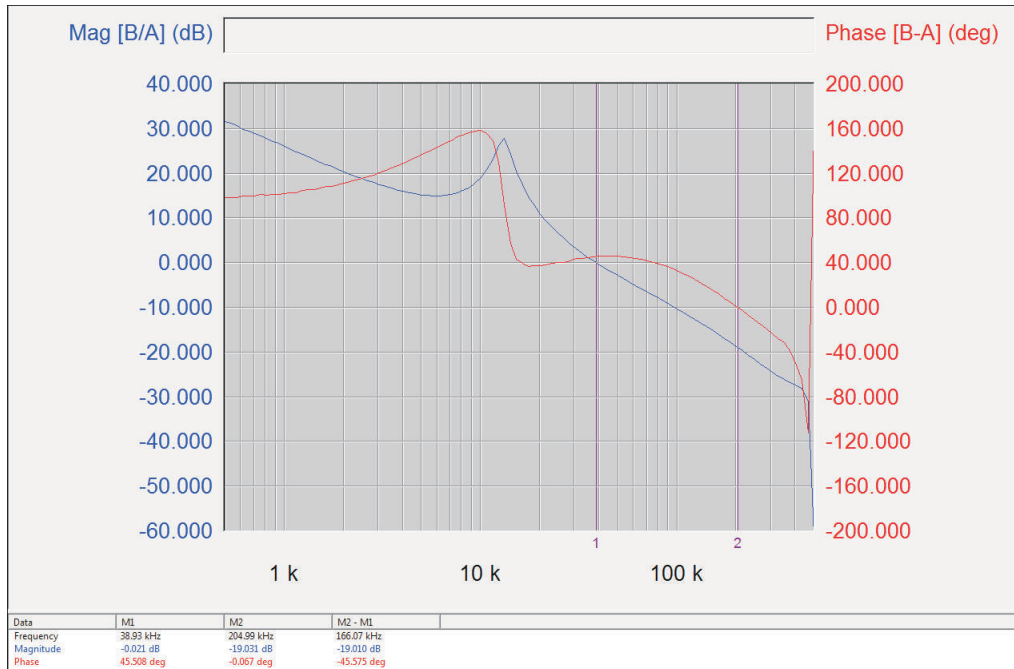
图 9-11. 环路增益 ( V_{IN} = 12V , V_{OUT} = 1.0V , I_{OUT} = 15A , 带宽 : 39 kHz , 相位裕度 : 46^\circ )
