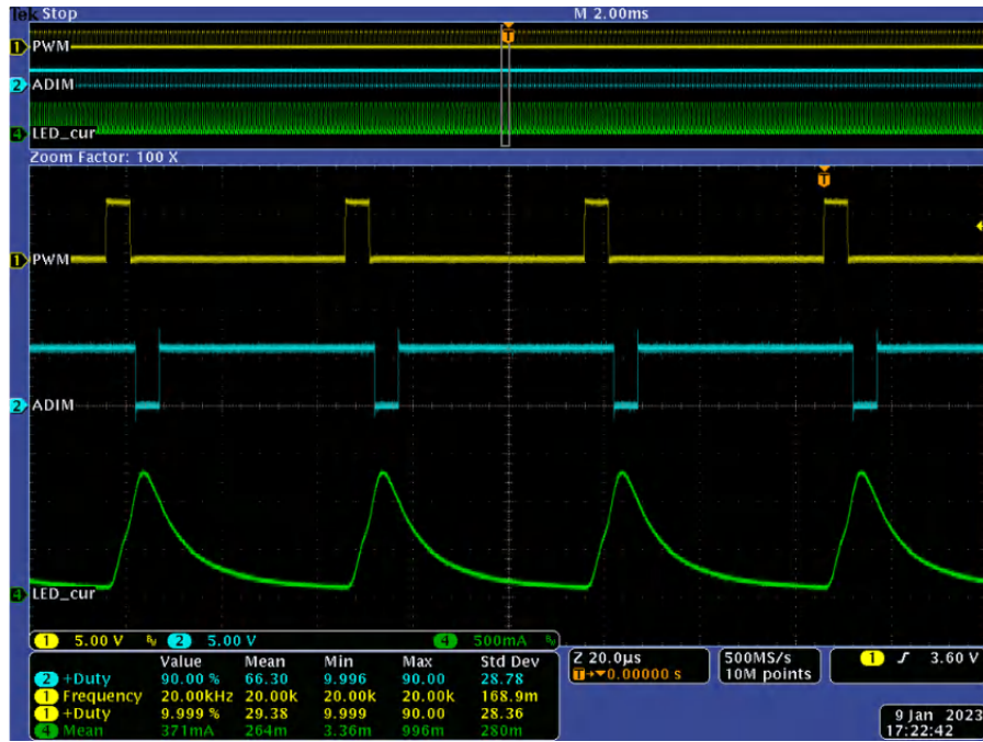
图 5-16. 90% 占空比 ADIM/HD 和 10% 占空比 PWM/EN 时的波形
