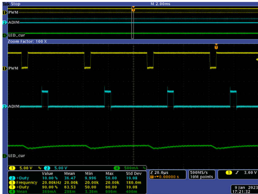
图 5-15. 10% 占空比 ADIM/HD 和 90% 占空比 PWM/EN 时的波形
