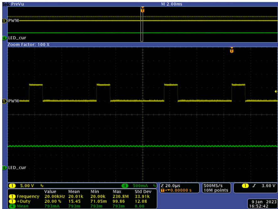
图 5-12. 20% 占空比、20kHz 混合调光时的波形
