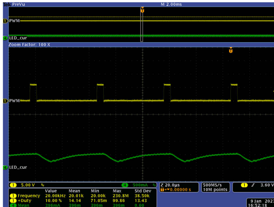
图 5-11. 10% 占空比、20kHz 混合调光时的波形
