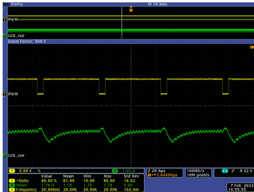
图 5-9. 90% 占空比、20kHz PWM 调光时的波形
