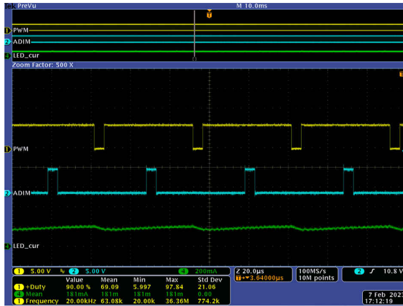
图 5-15. 10% 占空比 ADIM/HD 和 90% 占空比 PWM/EN 时的波形
