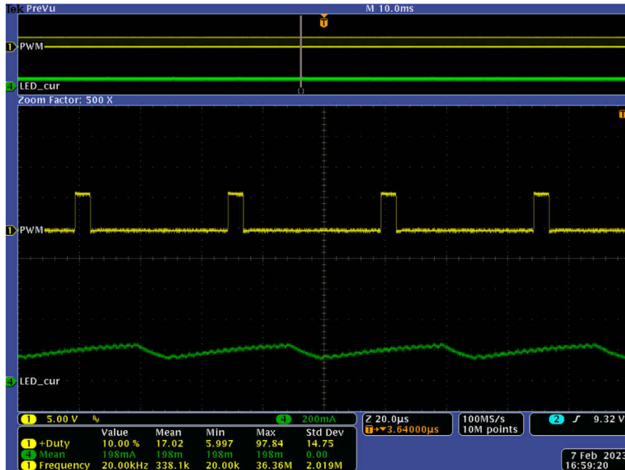
图 5-11. 10% 占空比、20kHz 混合调光时的波形
