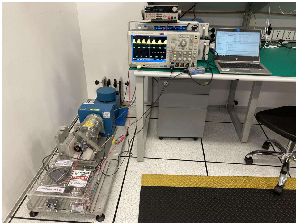
图 4-13. 负载测试设置
