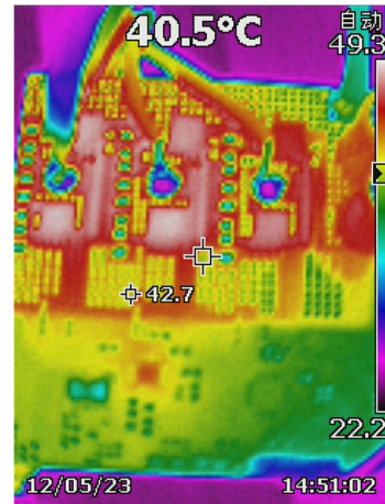
图 4-10. 10A RMS 绕组电流、15% 占空比时的热图像
