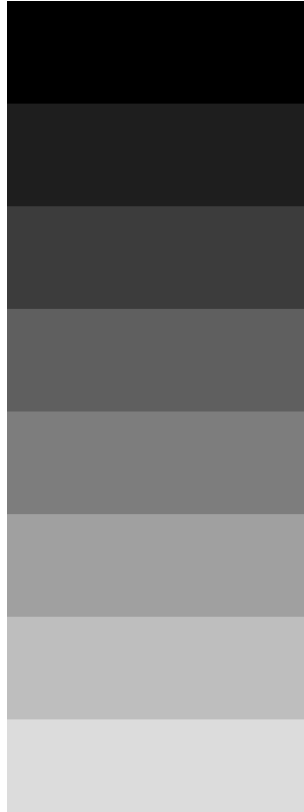
图 3-3. 固定步长垂直斜坡测试图形示例
