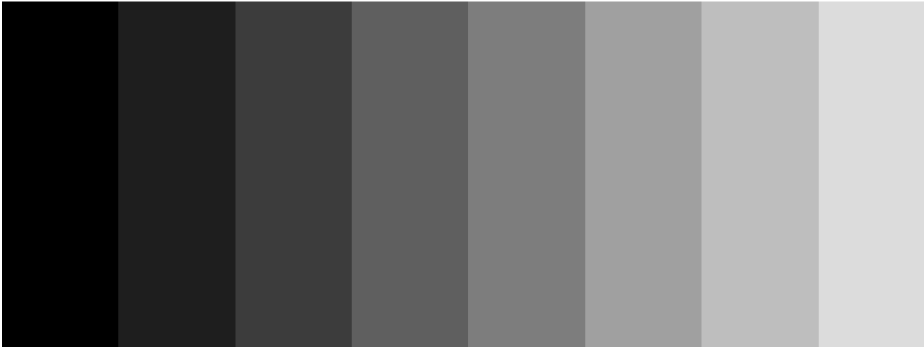
图 3-2. 固定步长水平斜坡测试图形示例
