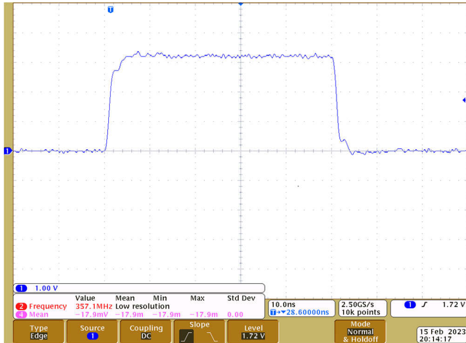
图 4-19. U7 处的 SCLK，U8 处具有交流并联端接
