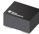
图 3. TMP61 线性热敏电阻提供穿孔和表面贴装 0402 和 0603 尺寸选项。
