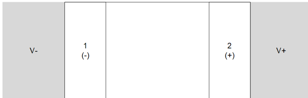
図 8-14. 推奨レイアウト : DEC パッケージ
