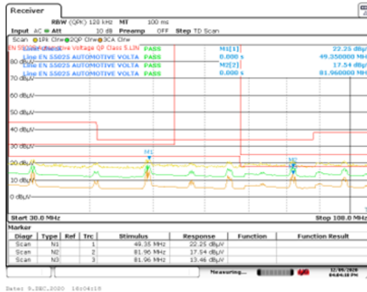
그림 4. 절연 5V 레퍼런스 설계(인터리빙 레이어 포함) 전도성 방출 대비 CISPR 25 클래스 5, 30~108MHz: 4.5dB 마진으로 통과했으며, 최악의 경우 82MHz에서 "CISPR 평균" 검출이 발생했습니다. 출처: 텍사스 인스트루먼트
