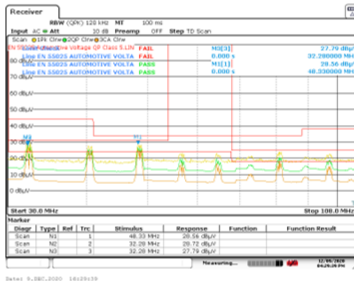
그림 5. 미출시 보드(인터리빙 레이어 없음) 전도성 방출 대비 CISPR 25 클래스 5, 30~108MHz: 3.8dB의 마진으로 실패했으며, 최악의 경우 32MHz에서 CISPR 평균 검출이 발생했습니다. 출처: 텍사스 인스트루먼트
